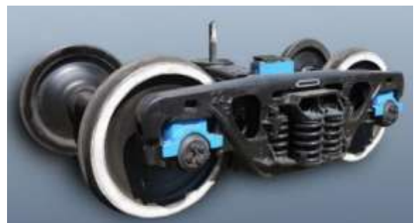
Рисунок 2.7 – Візок моделі 18-7020 ПАТ «Крюківський вагонобудівний завод» (Україна) [83]
