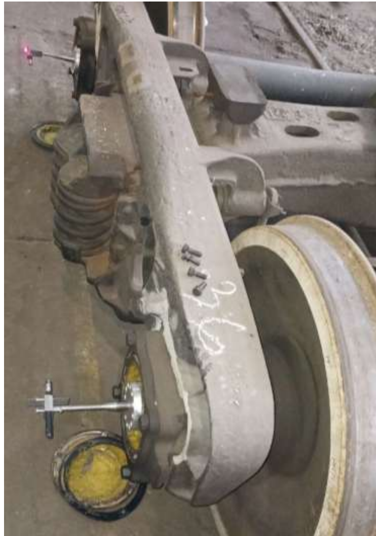
Рисунок 4.8 – Установка вимірювальних блоків безпосередньо на торцях осей колісних пар
